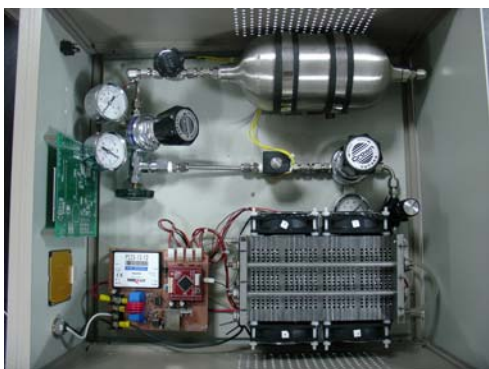
그림 4 개발된 소형 PEM 연료전지 전원 시스템 Fig. 4 Developed small PEM fuel cell power system
